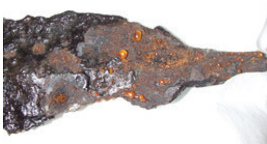
Слика 20. Појава „суза” на површини гвозденог предмета услед присуства хлорида
