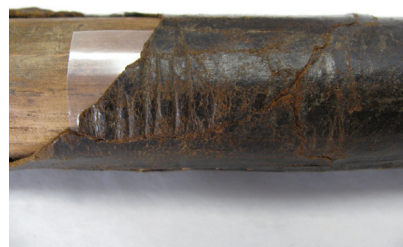
Слике 30–32: Фазе подлепљивања коже коришћењем Beva 371 филма
