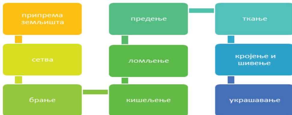
Схема 1: Процес добијања текстилних предмета од конопље
