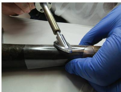
Слике 30–32: Фазе подлепљивања коже коришћењем Beva 371 филма
