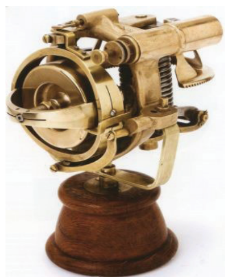
Prilog 4. Žiroskop iz tvornice Torpedofabrik Whitehead & Company, Rijeka 1897. – 1907., PPMHP Rijeka
